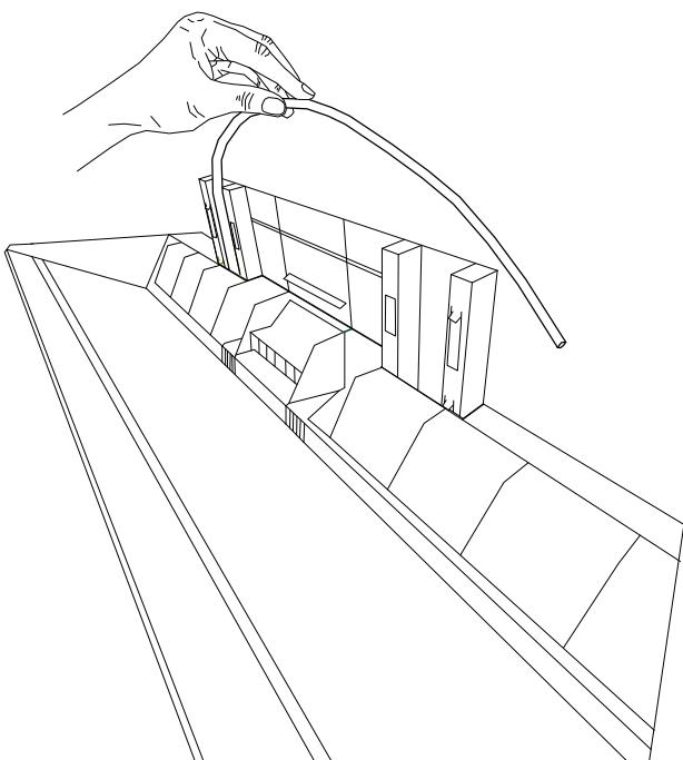
11) Na horním okraji vertikální stěny ohněte hadičku směrem k druhé drážce a ustřihněte na správnou délku tak, aby končila těsně nade dnem vrchní police.
