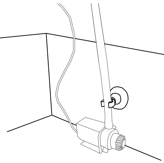
10) Protáhněte hadičku drážkou "water pipe". Hadičku připojte na výtlak čerpadla a v nádrži ji těsně nad čerpadlem přichytě přísavkou ke stěně. Tím zajistíte stabilní pozici čerpadla.
