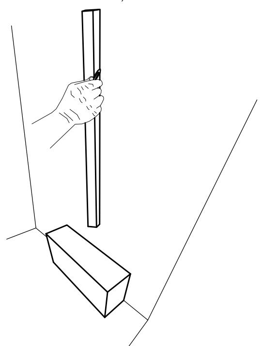
3) Nakreslete si svislici v ose montážních otvorů. Pracujte přesně, vodorovný a svislý směr je pro správnou funkci vertikální zahrady zásadní.
