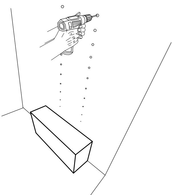
6) Vyvrtejte díry pro hmoždinky (volte vrták podle zvolené hmoždinky). Vložte hmoždinky.
