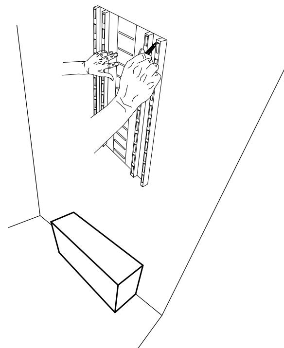
5) Postupně od spodní čáry přikládejte základní desky. Označte si pozici montážních otvorů a horní okraj desky. K tomu pak přiložte další desku (zkontrolujte vodorovnost) a pokračujte v označování montážních otvorů.
