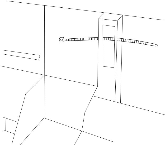
**14) Zajistěte pozici hadičky v horní polici stažením stahovací pásky.**
